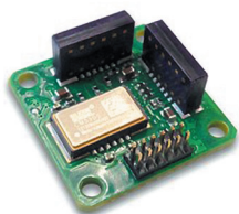
Рис. 4. Инерциальный МЭМС-модуль DMU11 компании Silicon Sensing
